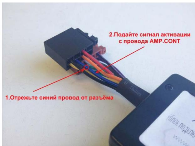
Следующим этапом необходимо подключить провод, который будет активировать оригинальный усилитель. Сигнал активации необходимо снимать с дополнительного провода блока согласования, это отдельный провод голубого цвета.
