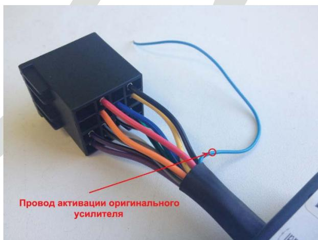
Сигнал с этого провода необходимо подать на провод оригинального разъёма «С», предварительно отрезав провод от разъёма.
