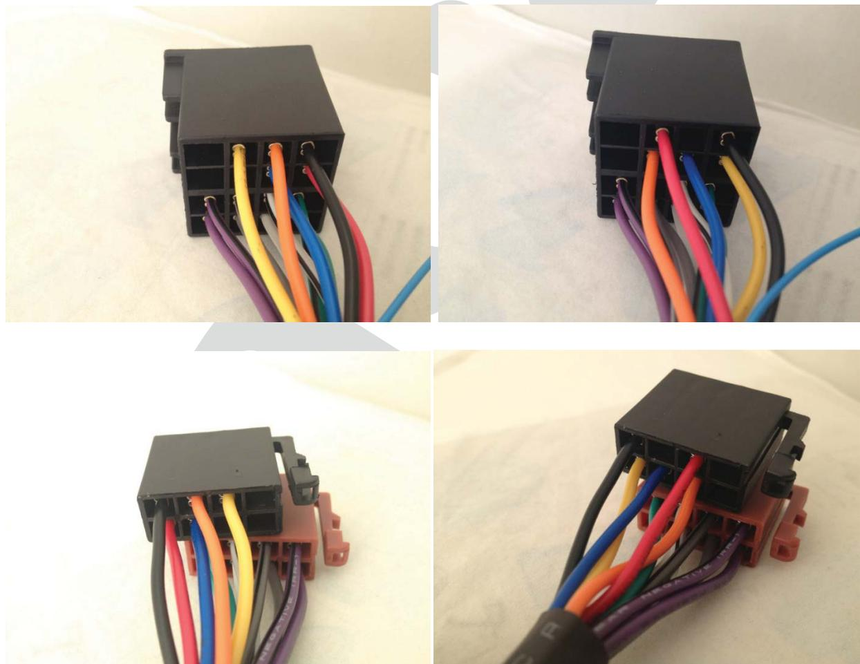
Когда положение проводов в разъёмах приведено к стандартам автомобиля, переходим к подключению проводов головного устройства к проводам адаптера и к проводам оригинальной проводки автомобиля.
